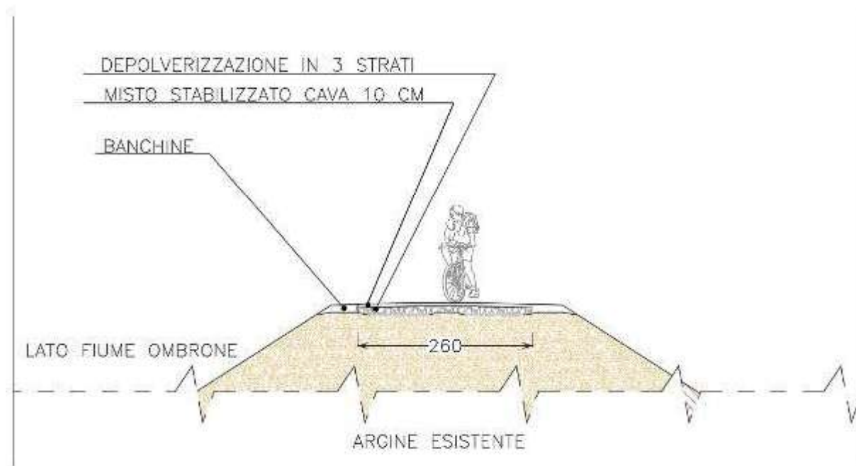
Figura 21 Sezione intervento tratto A-B
